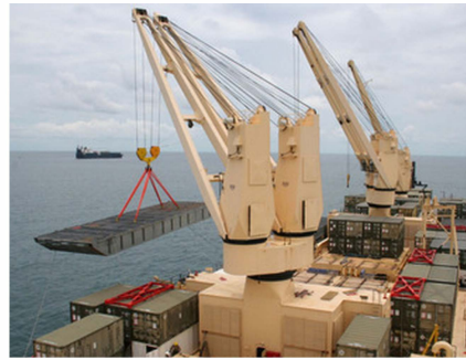
克令吊 Deck crane
